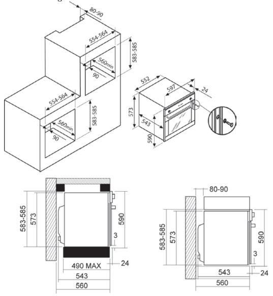
UNDER BENCH INSTALLATION TOWER INSTALLATION
